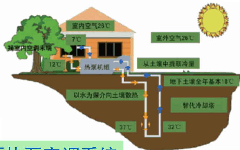
垂直埋管土壤源地源热泵空调系统
